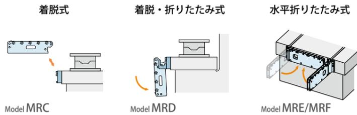
着脱式 (スタンド取付タイプ)      水平折りたたみ式 (スタンド取付タイプ)
