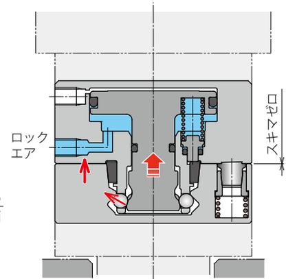
リリースエアポートにエアを供給します。ピストンロッドはリリースエアによる推力で押下げられた状態になります。このとき鋼球はフリー状態（内側に収まる）となります。
