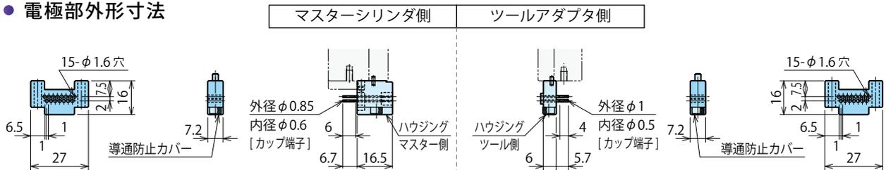
● 外形寸法 (SWR0070/SWR0120/SWR0250/SWR0500/SWR0750/SWR2300 時)
