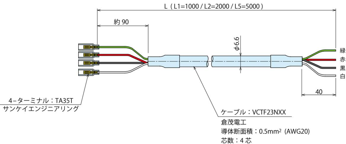
※本図を参考に客先殿にてケーブルを製作する場合、適合ターミナル (TA35T) を圧着する際の圧着工具は別途必要となります。
