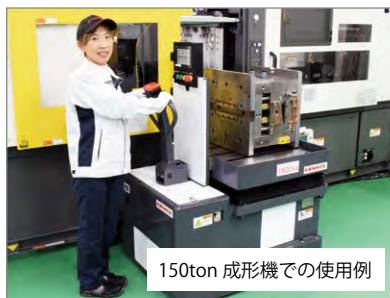
手元のボタンで電動走行をコントロール
