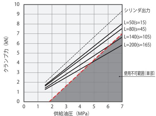
**LHS0750** クランプ力計算式<sup>※1</sup> (kN)  $F = P(1-0.0007 \times L) / (0.5175+0.0006 \times L)$
