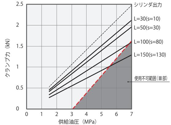
**LHS0400** クランプ力計算式<sup>※1</sup> (kN)  $F = P(1-0.0016 \times L) / (2.0920+0.0040 \times L)$
