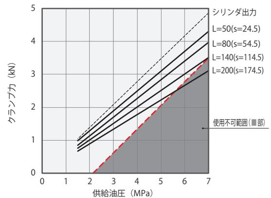
**LHS0550** クランプ力計算式<sup>※1</sup> (kN)  $F = P(1-0.0011 \times L) / (1.0039+0.0011 \times L)$
