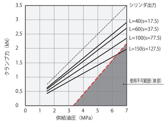
**LHS0480** クランプ力計算式<sup>※1</sup> (kN)  $F = P(1-0.0009 \times L) / (1.4892+0.0018 \times L)$
