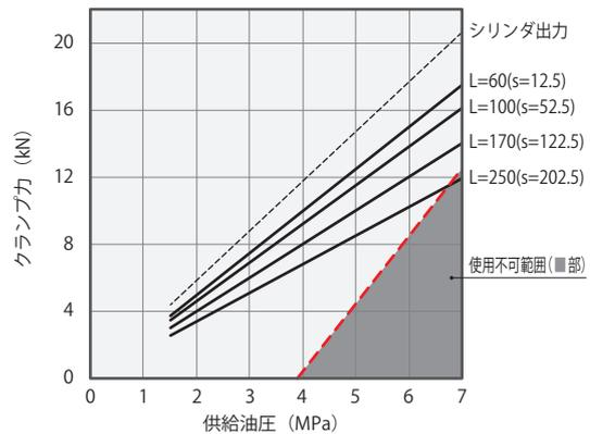
**LHS1050** クランプ力計算式<sup>※1</sup> (kN)  $F = P(1-0.0008 \times L) / (0.2495+0.0002 \times L)$
