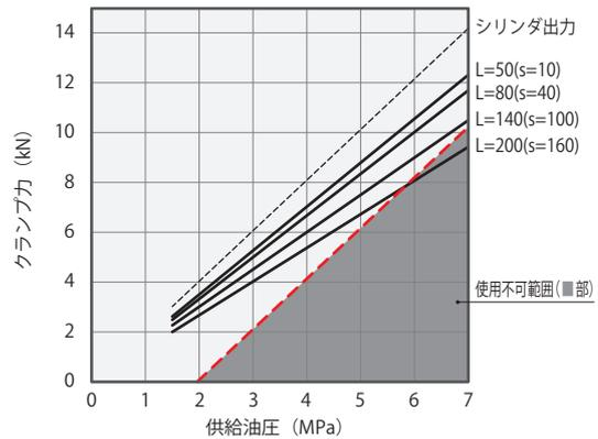
**LHS0900** クランプ力計算式<sup>※1</sup> (kN)  $F = P(1-0.0009 \times L) / (0.3547+0.0004 \times L)$
