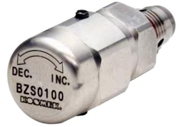
ダイレクトマウント形シーケンスバルブは、配管方式：Cタイプの油圧クランプに直付け可能なGネジ専用のシーケンスバルブです。アクチュエータの動作順序を簡単で確実な制御することが可能です。
