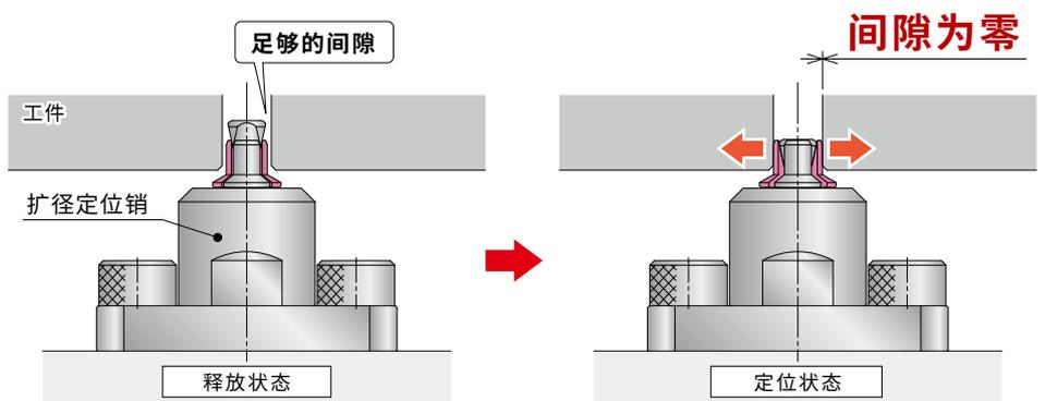
扩径定位销的 **间隙为零!!**
