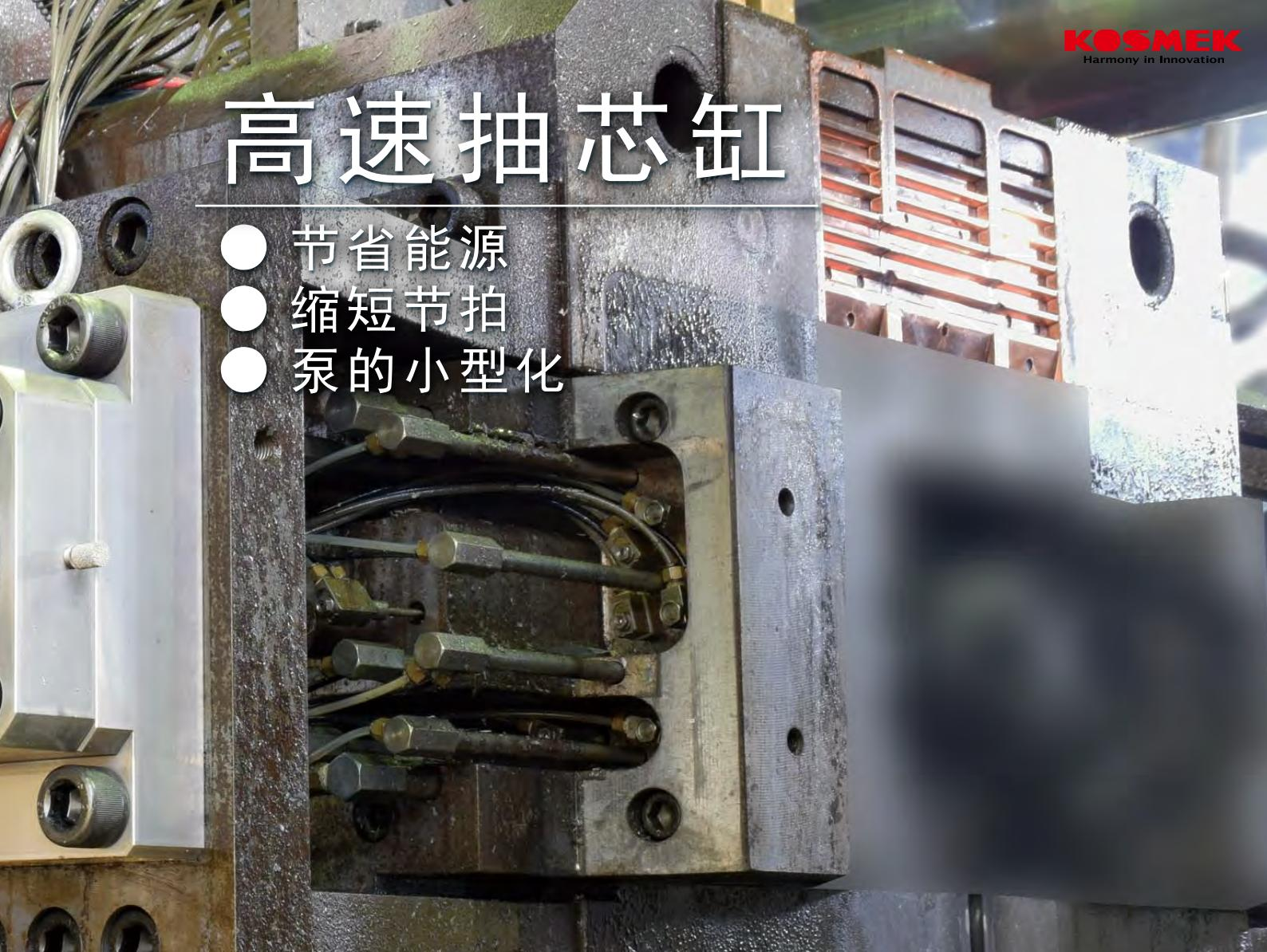
高速抽芯缸 是通过降低油缸容量,使油缸动作加快, 来实现有效缩短节拍。
